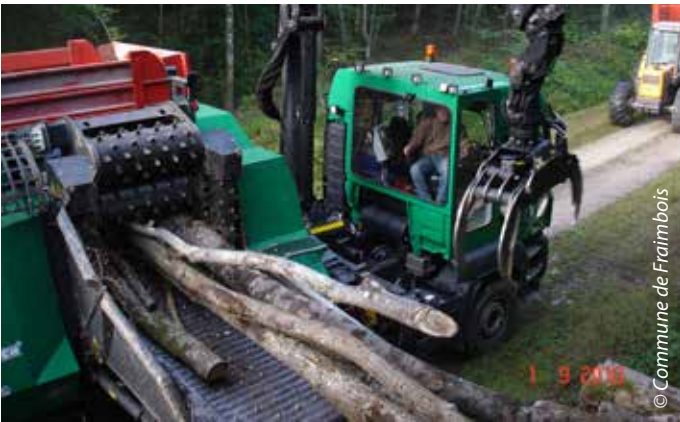
Transformation du bois de la forêt communale en plaquette forestière pour alimenter la chaufferie collective (Frambois)
