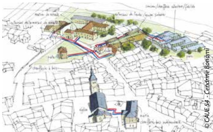
Schéma de principe d'un réseau de chaleur communal. Dessin issu du livre «2054 Voyage en transition» représentant un futur réseau à Thiaucourt.
